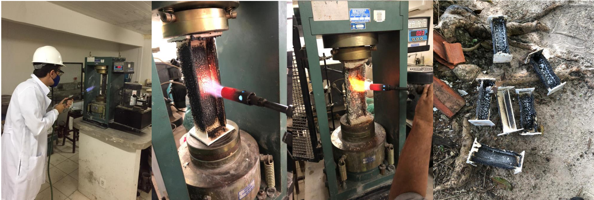
Figura 5 - Experimentos com proteção passiva contra incêndio
