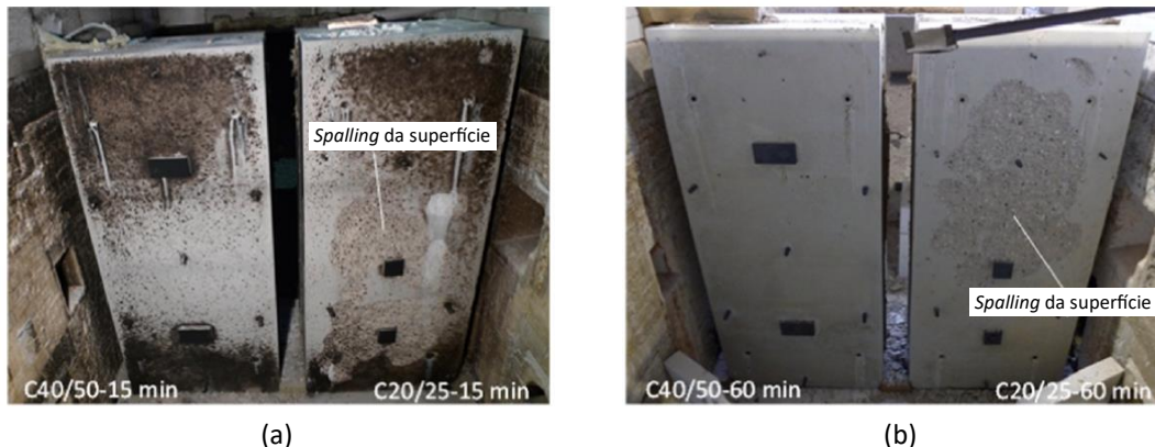
Figura 19 – Efeitos do fogo nos protótipos de concreto após (a) 15 minutos e (b) 60 minutos de incêndio-padrão.
