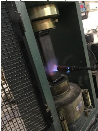
Figura 13 - Aplicação de fogo no perfil U durante ensaio
