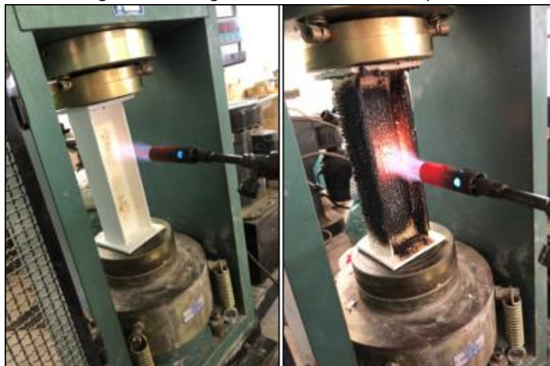
Figura 14 - Estágios de intumescência em perfil I
