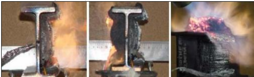
Figura 6 - Expansão volumétrica da tinta intumescente
