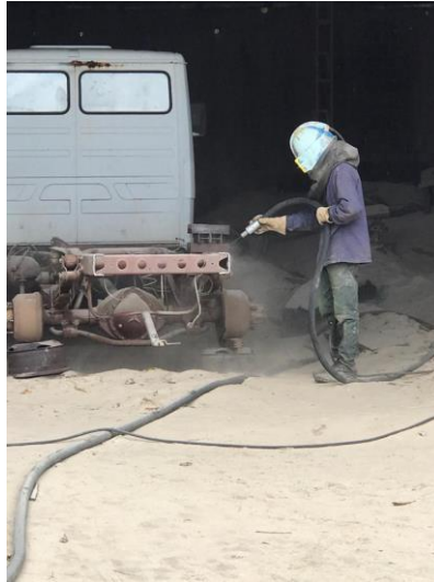
Figura 9 - Jateamento de areia nos corpos de prova
