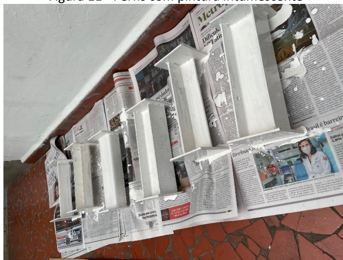
Figura 11 - Perfis com pintura intumescente
