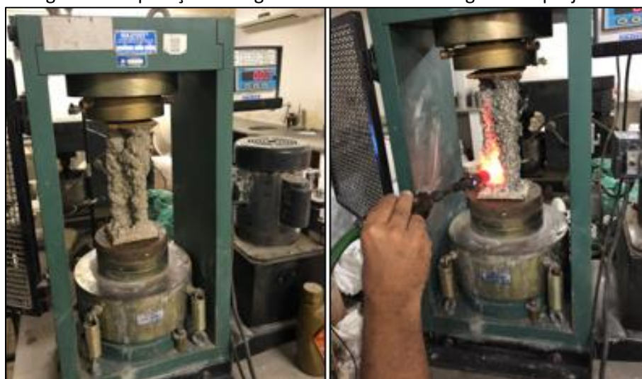
Figura 15 - Aplicação de fogo em cantoneira com argamassa projetada
