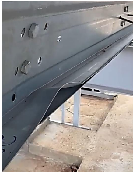
Figura 3.3: Falha por flambagem distorcional acontecendo no ensaio das terças. Fonte: os autores.
