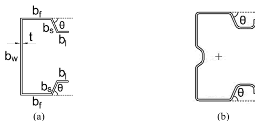
Figura 14: Geometria da seção rack: (a) seção típica estudada, (b) exemplo de seção rack adotada por fabricantes de sistemas porta paletes.
