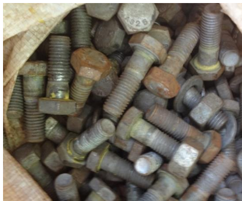
Figura 25 – Parafusos A325 galvanizados a fogo - reutilizados
