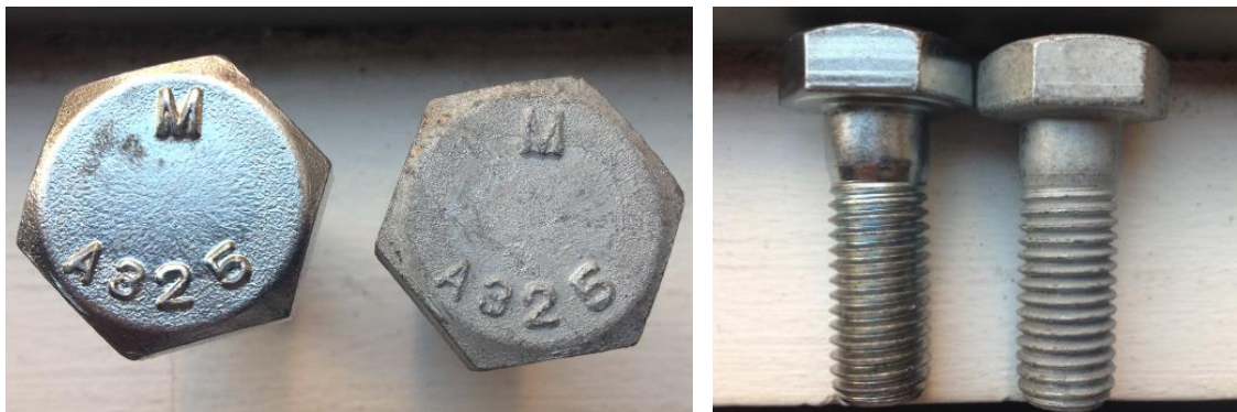
Figura 18 – Parafusos A325 5/8" (Esq.) Eletrolítico e (Dir.) Galvanizado a fogo
